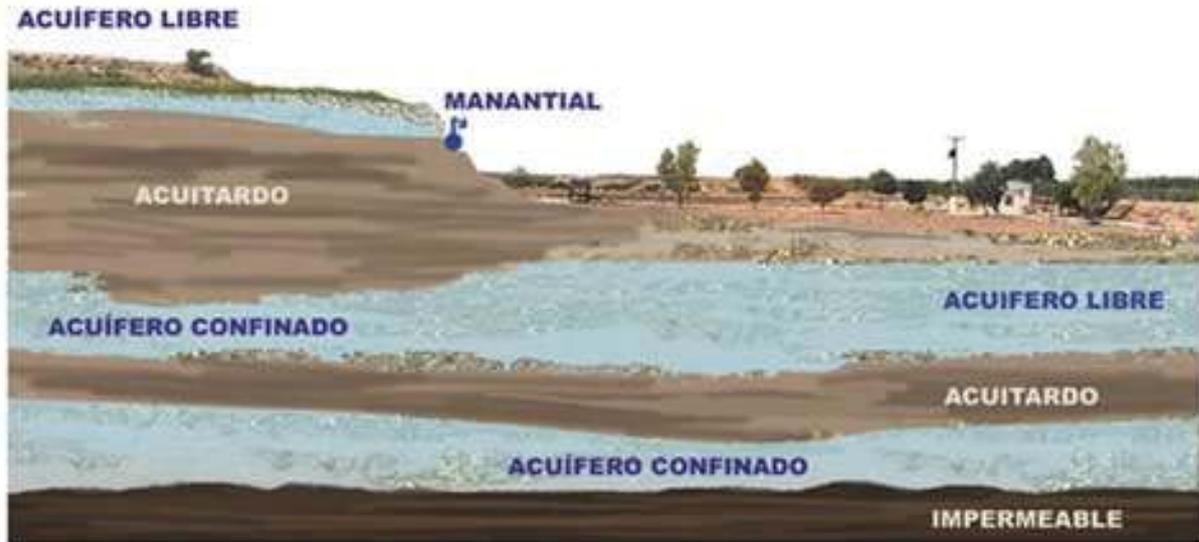
Figura 19 Esquema distintos tipos de acuíferos. Fuente: <https://hispagua.cedex.es/datos/hidrogeologia>
